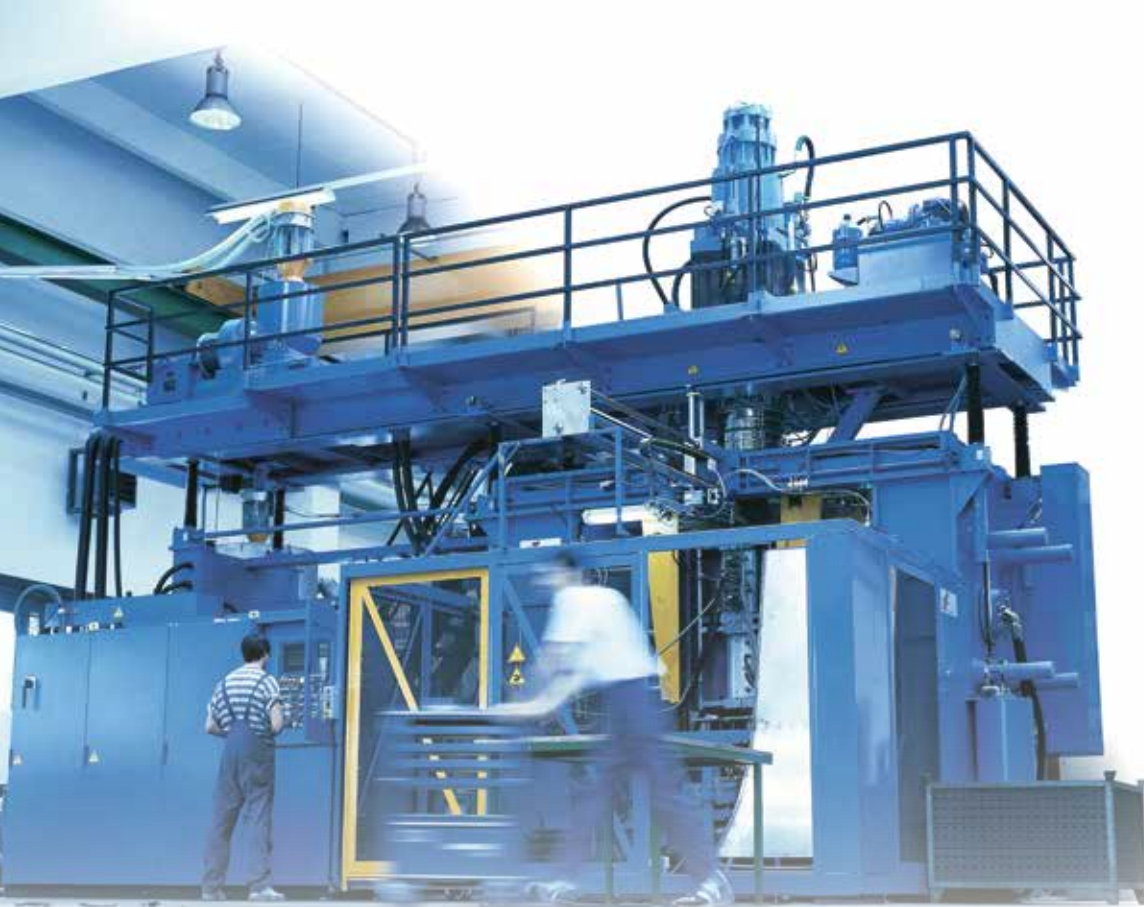
Extrusionsblasmaschine zur Herstellung doppelwandiger Koffer.
